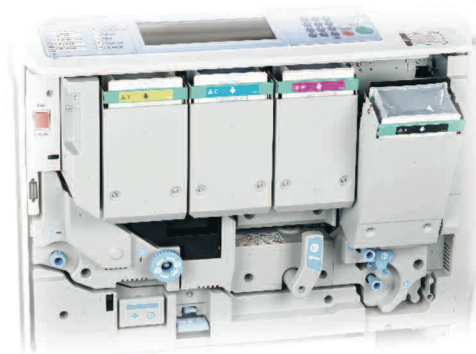
El reemplazo del toner es literalmente un proceso de tres pasos con el nuevo sistema de tanque de alimentación.
